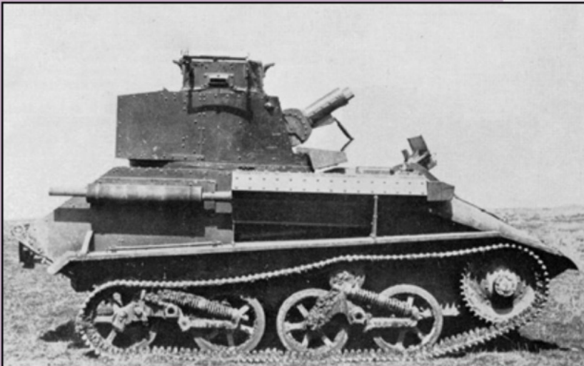
▲ Lichte Tank Mark VI, uitgerust met een tweepersoons toren en bewapend met een .303 inch en een .5 inch machinegeweer in dubbelopstelling.
