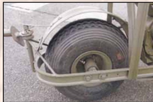
Boven: het achterwiel met aan het spatbord de stang waaraan het aanhangertje wordt aangehaakt.
