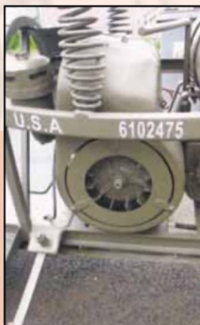
Links: de ventilator voor de koeling met rechts daarnaast de versnellingshendel.
