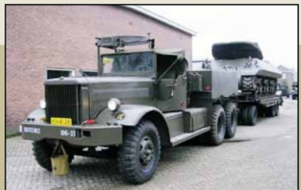
De Diamond T Type 981 M20 trekker met Rogers trailer en daarop een M10A1 Achilles van de Rekvisietencommissie K.L. (foto Wim den Dunnen)
