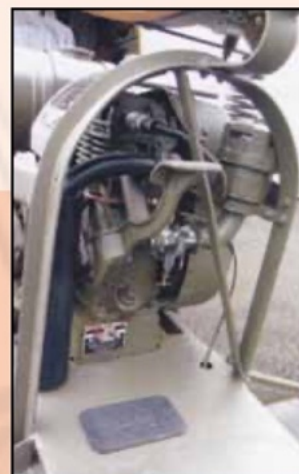
Links: de ventilator voor de koeling met rechts daarnaast de versnellingshendel.
